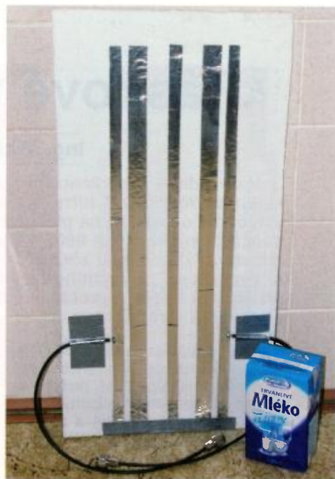
Obr. 4. Filtr 80 MHz s malou selektivitou
