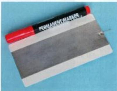
Obr. 1. Zkušební kondenzátor připravený k měření
